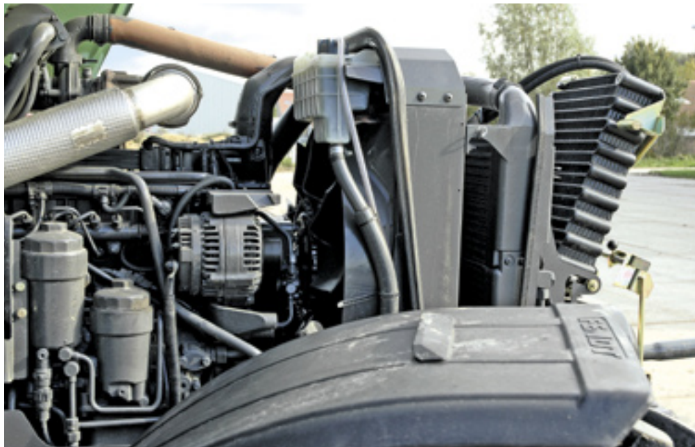
▲ De Deutz viercilinder is voorzien van een turbo en intercooler en springt bijzonder zuinig met brandstof om. Het reinigen van de koelers is vrij goed uitvoerbaar.
