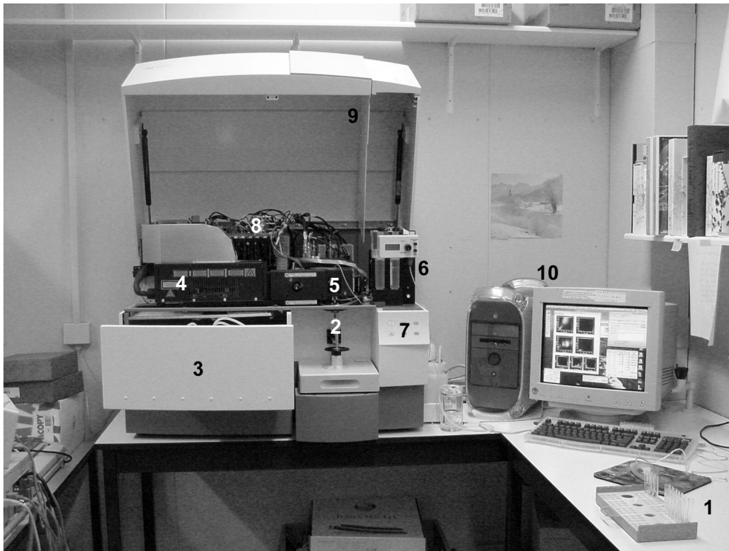
Fig. 6. De flow cytometer, 'FACSCalibur' die gebruikt is in dit onderzoek. 1 = monsters, 2 = naald voor de monsteropname, 3 = lade een containers voor loopvloeistof en afvalvloeistof, 4 = laser, 5 = meetcel, 6 = sorteerbuisjes, 7 = controlepaneel, 8 = elektronica, 9 = kap (normaal dicht) en 10 = computer voor de aansturing van de flow cytometer en de data verwerking.
