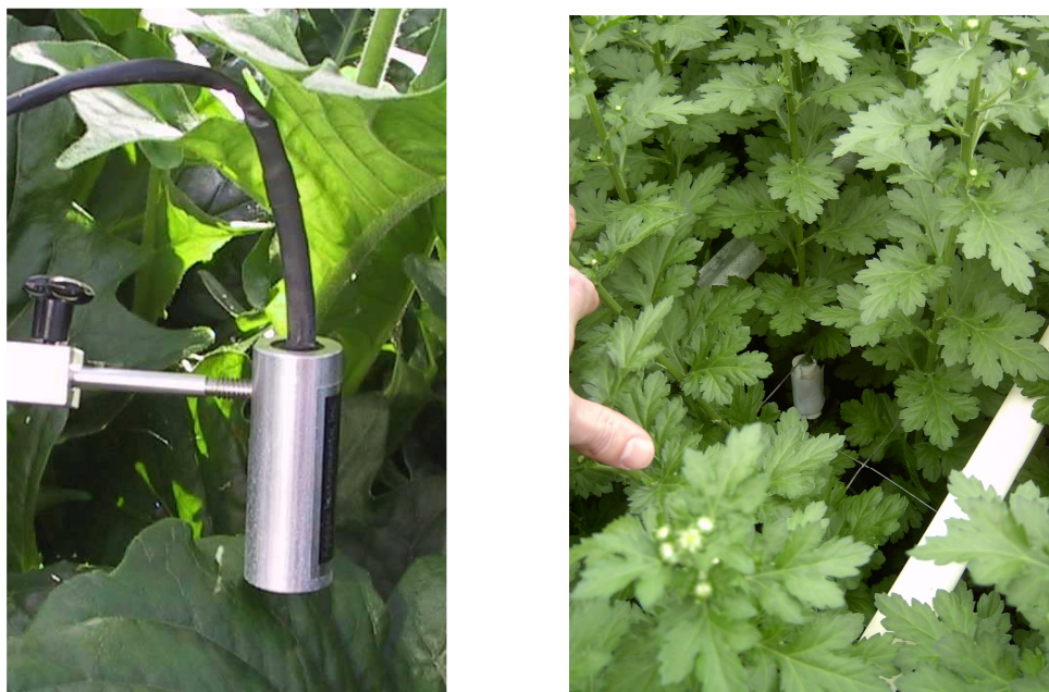
IR meting voor bladtemperatuurmeting op buishoogte (links) en sapstroommeting (rechts)
