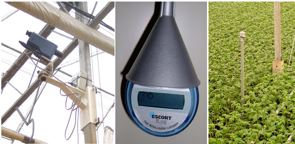
V.l.n.r.: Infraroodcamera voor meting planttemperatuur, mini-datalogger voor RV en temperatuur in gewas, PAR meter
