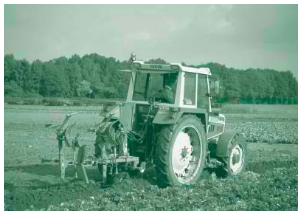
Voor iedere teelt wordt geploegd. De kerende grondbewerking is een effectieve methode voor de onkruidbestrijding
