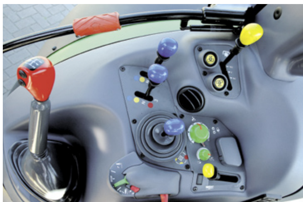
Overzichtelijkheid kenmerkt de rechterconsole van de huidige Agrotion 150 (hier in standaarduitvoering). De heldere signaalkleuren zijn nu volledig geaccepteerd, maar werden in eerste instantie door veel potentiële kopers als kinderlijk ervaren. De sterk aflopende neus, het futuristische uiterlijk van de cabine en de overname van Deutz-Fahr door Same wierpen in het begin ook wat drempels op.
