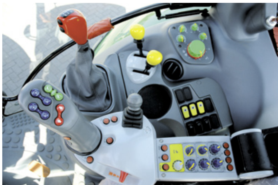
De rechterconsole herbergt bij de M ook de pook (linksboven) van de ZF-zesbak. Die wordt nu via bowdenkabels bediend en maakt daardoor een kortere slag dan bij de huidige Agrotion. Op de voorgrond de armleuningbediening van de profiline-uitvoering. Bij de nieuwe M krijgt ook de standaardversie een deel van de bediening op de armleuning.
