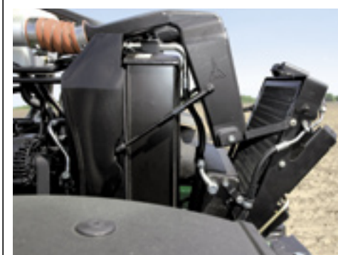
Het koelpakket op de M620 vouwt makkelijk uit en is dan probleemloos te reinigen.
