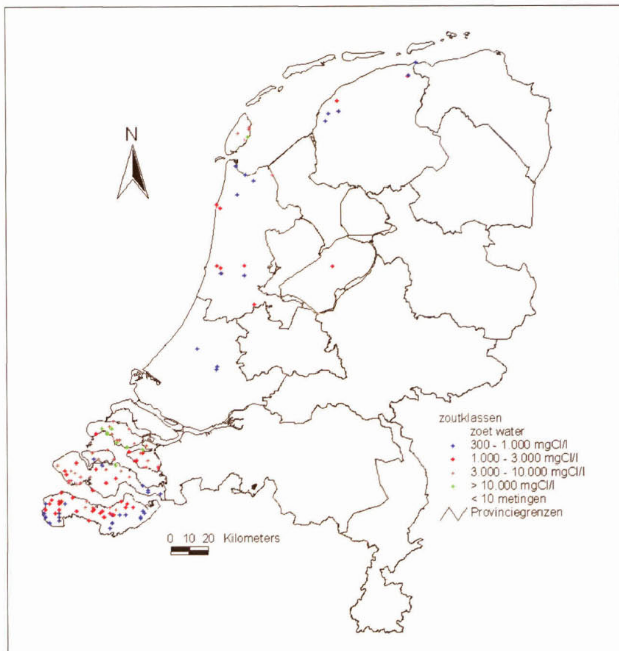
Figuur 4.2 Overzicht van de verdelingen van de hoofdwatertypen in Nederland (monsterpunten met minder dan 10 chloridemetingen zijn niet ingedeeld)
