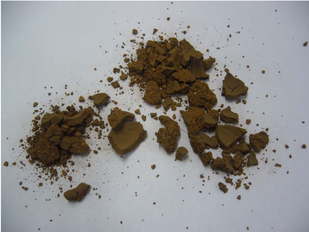
Foto van uit drains gespoeld particulier materiaal.
