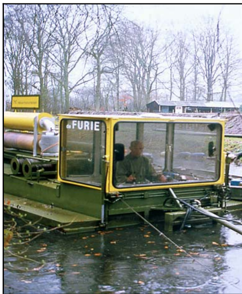
Fig. 13: Baggerboot voor herstel van het Naardermeer
