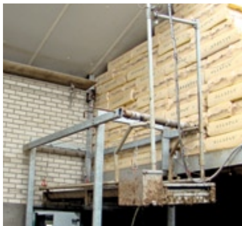
Met een hijsinstallatie til je de goot omhoog wanneer je hem niet gebruikt.
