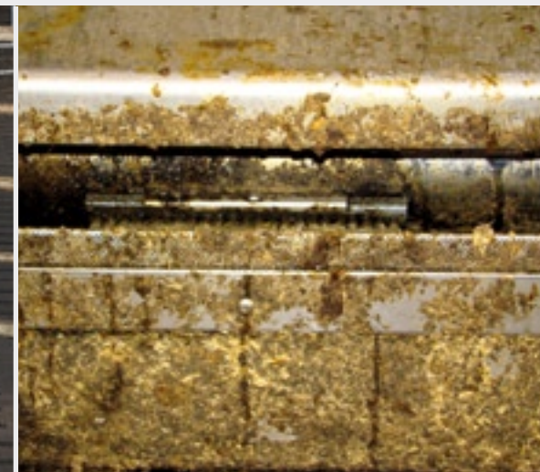
De zeef wordt schoongehouden door een ronddraaiende borstel.
