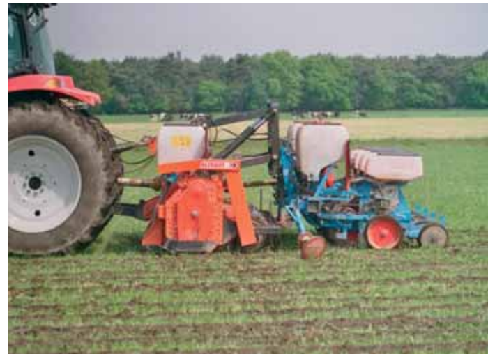
Hakenfrees van Althaus voor het frezen van stroken (24 cm) en direct zaaien van maïs.
