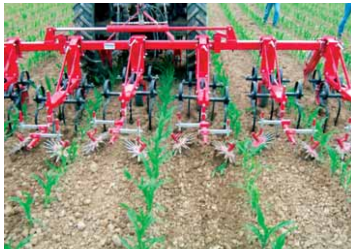
De vingerwieder pakt het onkruid in de rij optimaal aan.
