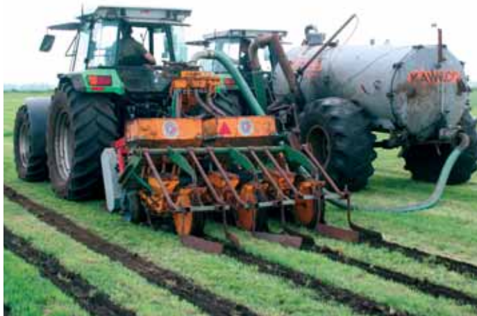
Pennenfrees van Henk Pol voor het frezen van stroken (12 cm) en direct zaaien van maïs.
