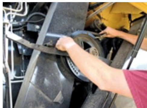
▲ Het toerental van de tweede trommel verander je door een V-snaar op een kleinere of grotere poelie te leggen. Aan- en ontspannen doe je met de grote hendel links.
