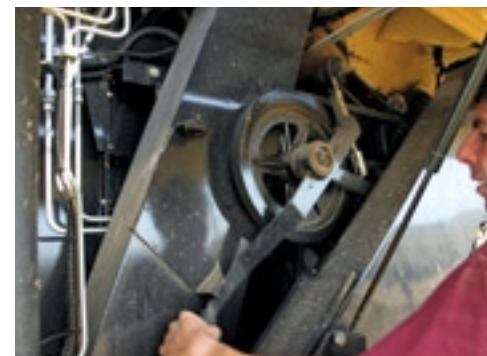
▲ Het toerental van de tweede trommel verander je door een V-snaar op een kleinere of grotere poelie te leggen. Aan- en ontspannen doe je met de grote hendel links.
