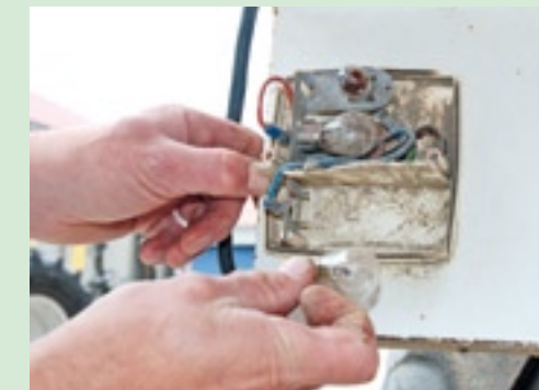
▲ In een samengestelde lamp zijn het achterlicht, de richtingaanwijzer en het stoplicht samengebracht. Iedere lamp heeft zijn eigen sterkte. Monteer bij vervanging een lamp met het juiste vermogen. Ook controle op beschadiging van het glas is van belang. Bij een beschadigd glas is de kans op vervuiling en corrosie veel groter en dit geeft meer problemen bij de stroomdoorvoer naar de lamp. Maak ook het glas aan de buitenkant regelmatig schoon.
