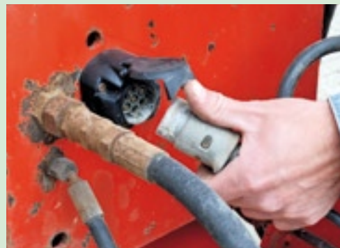
▲ De aansluitkabel ligt vaak los en de kans bestaat dat deze ergens in de klem komt. Een mogelijkheid om dit te voorkomen is een stekkerdoos te plaatsen op de aanhanger. Tussen de trekker en de wagen kan dan een losse kabel komen met aan elke zijde een stekker. Het is hierbij wel belangrijk dat je bij het aansluiten altijd eerst de stekker van de wagenkant er insteekt en daarna de stekker van de trekker. Dit om mogelijke kortsluiting te voorkomen.
