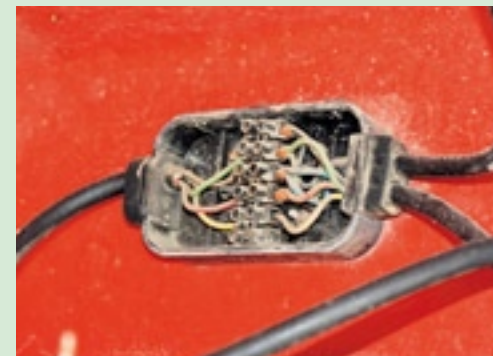
▲ Wanneer de stekker en de kabel goed zijn, komt onder de wagen de verdeelkast. Hierbij wordt de kabel gesplitst naar de verschillende lamp-eenheden aan de linker- en rechterkant van de wagen. Door het schoonspuiten met een hogedrukreiniger kan er vocht en vuil in deze dozen komen. Dit kan corrosie tot gevolg hebben waardoor de stroom onderbroken wordt. Let ook op de goede plaats van de afdichting bij deze verdeelkasten.
