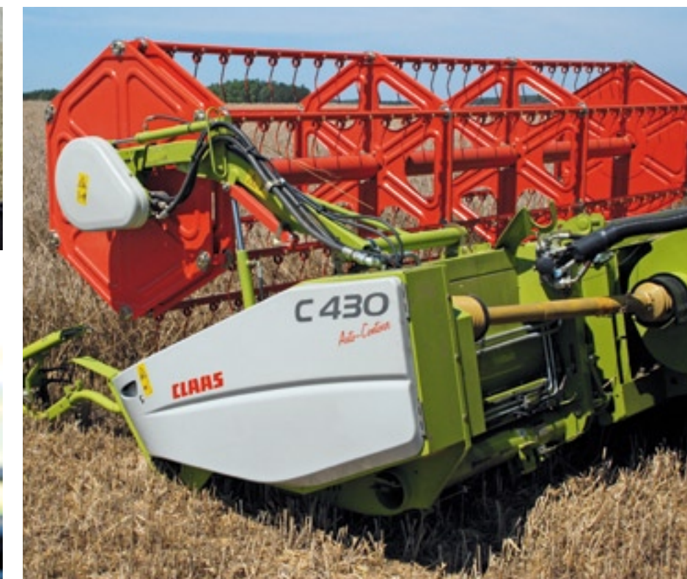
▲ Claas levert de nieuwe Avero maai bord met een werkbreedte van 3,7 tot 6,6 meter, ook als 'Vario' (5,4 en 6,0 meter) en opklapbaar (4,5 meter). Via de multikoppeling is het voorzetstuk eenvoudig af en aan te koppelen.
