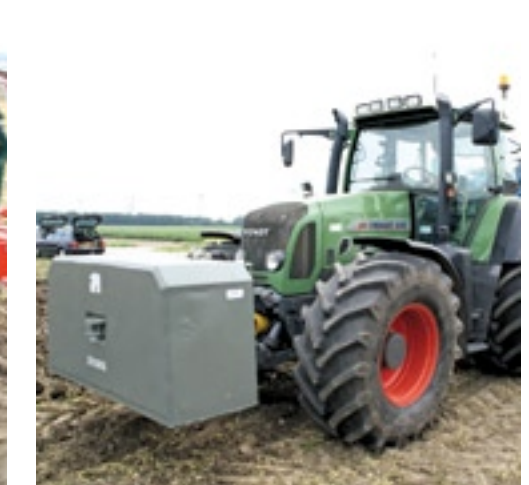
▲ Bij deze trekker met zesschaar passen de 900/50R42 banden net; frontbelasting vereist.
