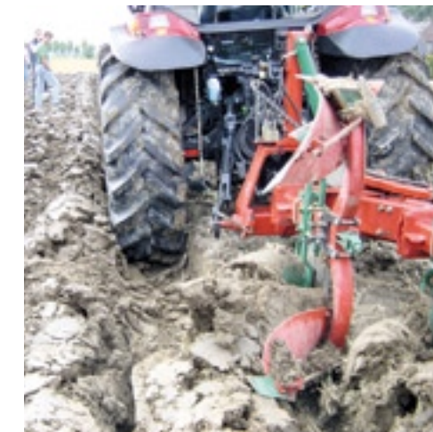
▲ Bij de reguliere ploegen is de ruimte in de ploegvoor beperkt tot een 650-band.
