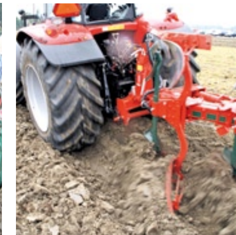
▲ Bij een ploeg met voorverbreder is nog te werken met banden van 710.
