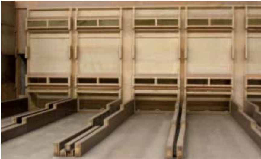
Snel droogwand voor bloembollen (zogenaamde stoffendroogwand)
