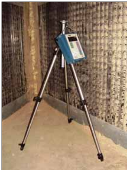
Figuur 5 A: Schematische weergave van het StuffNix systeem en de meetposities (afmetingen in cm) B: Meetopstelling met de DustTrak aan een driepoot C: Foto van de gang voorlangs de uitstroomzijde van de StuffNix opstelling; drie deuren staan open zodat achtereenvolgens kamers 4, 3, 2 en 1 zichtbaar zijn (foto genomen tussen ventilator 9 en 10)
