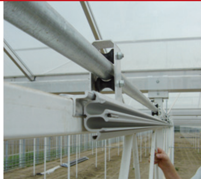
De ketting loopt rond; door de onderste gleuf heen, door de bovenste terug.
