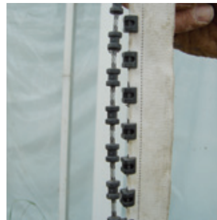
De haakjes van het doek grijpen vast in de ketting.
