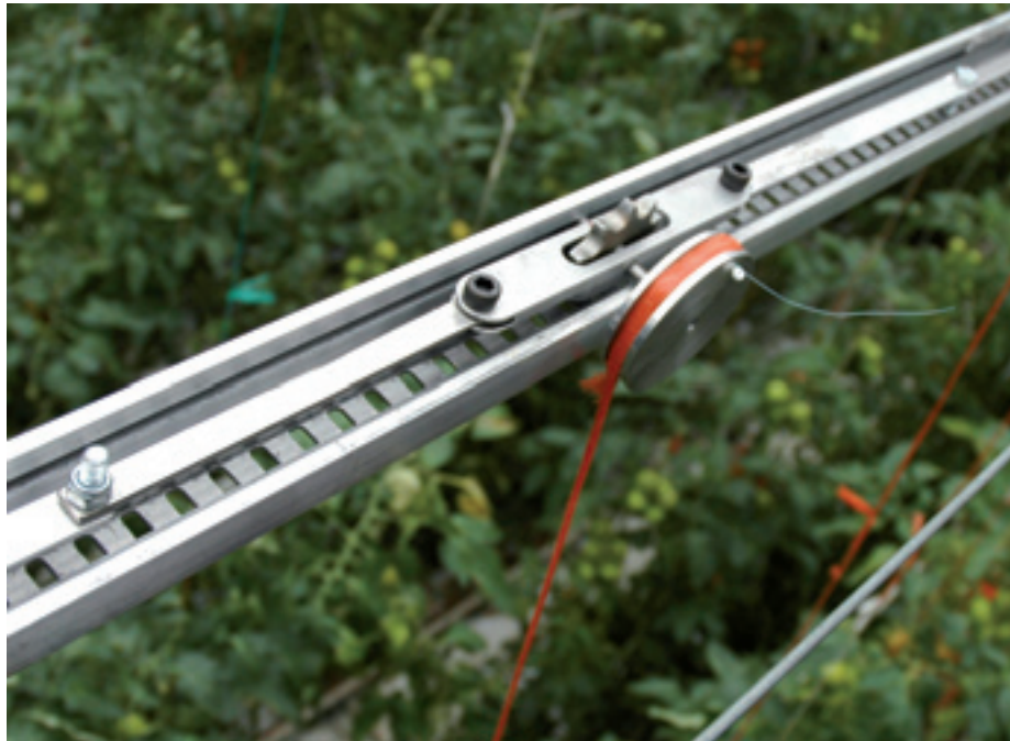
Het gewicht van de plant veroorzaakt een neerwaartse beweging. De katrol, verbonden met het tandwiel, zet dit om in een zijwaartse beweging.
