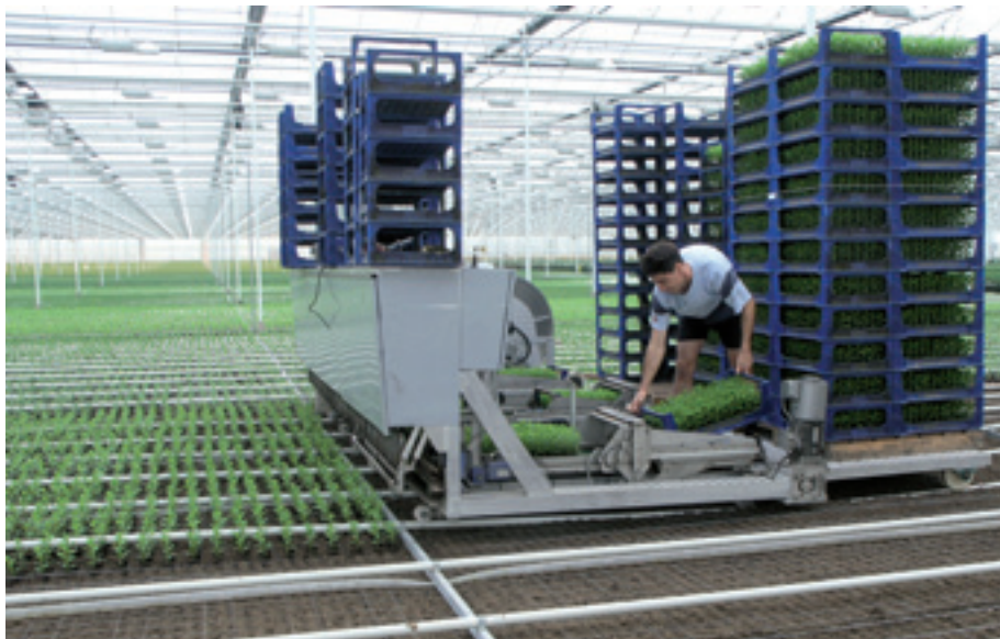
Bij de Roboplant moet de operator per minuut ongeveer 1,5 krat met perspotten in de uitduwers plaatsen en de lege kratten vanuit deze uitduwers oppakken en opstapelen.
