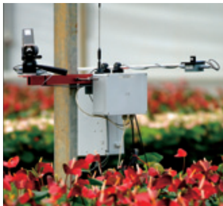
Plantsensoren geven extra informatie over de planttemperatuur (foto: Grow watch).
