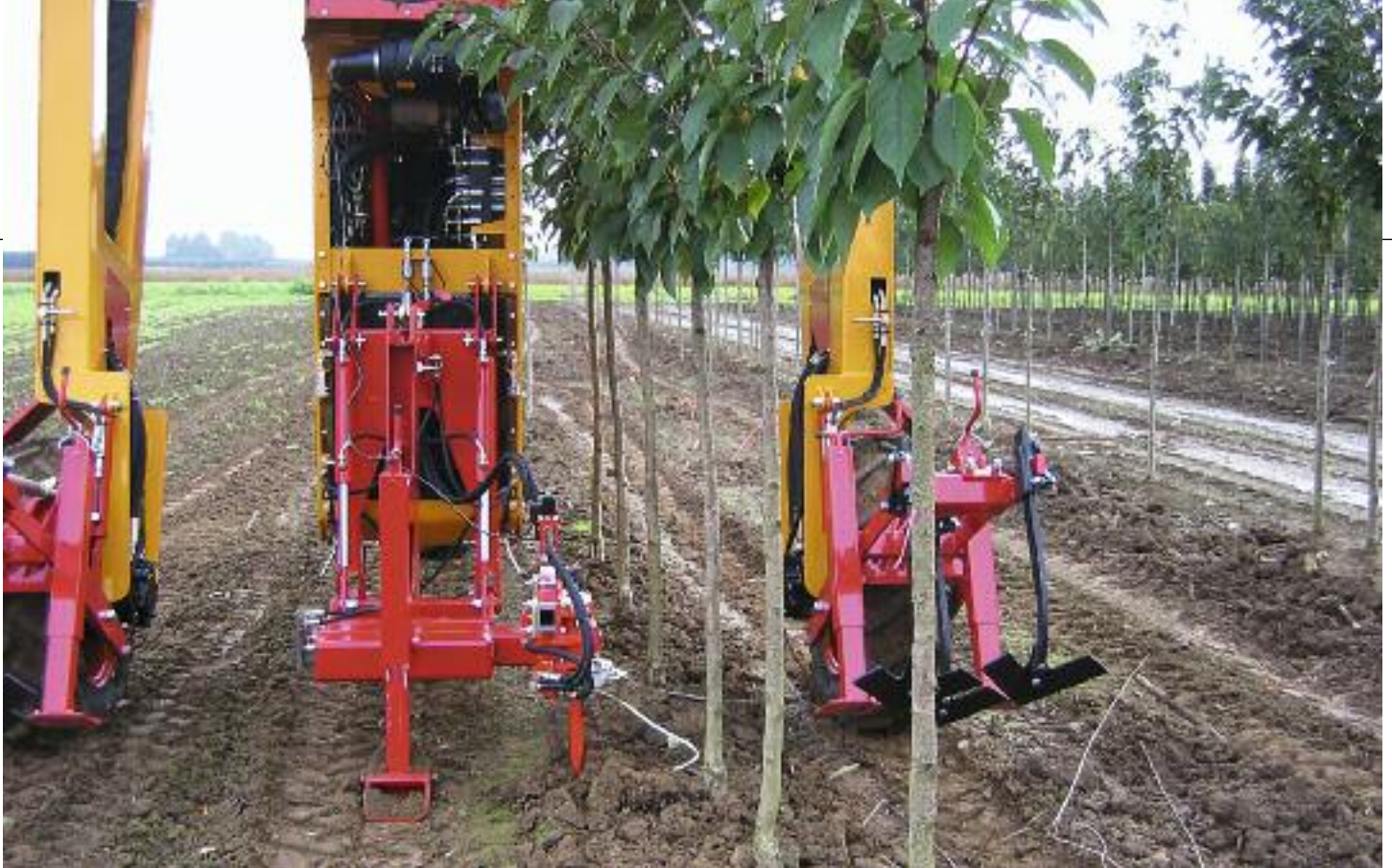
Telen met toekomst probeert nieuwe technieken uit, zoals schoffelgarnituur voor mechanische onkruidbestrijding in de spillenteelt van laanbomen.
