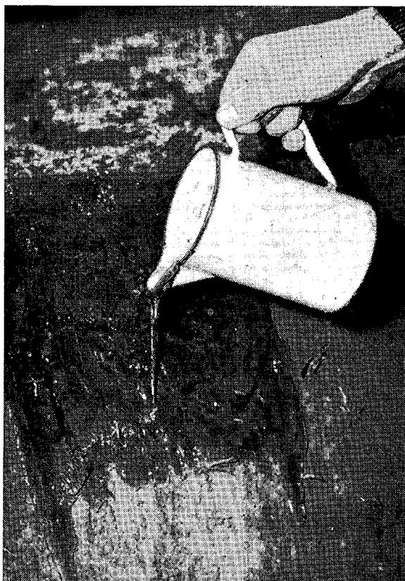
Fig. 1. Het opbrengen van lak op de profielwand. Putting lacquer on the face of the profile.
