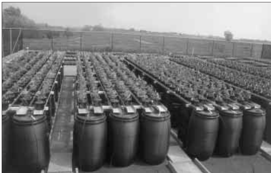
Overzicht van de proefopstelling met opvangvaten voor lekwater in het onderzoek naar de werking van langzaamwerkende meststoffen.
