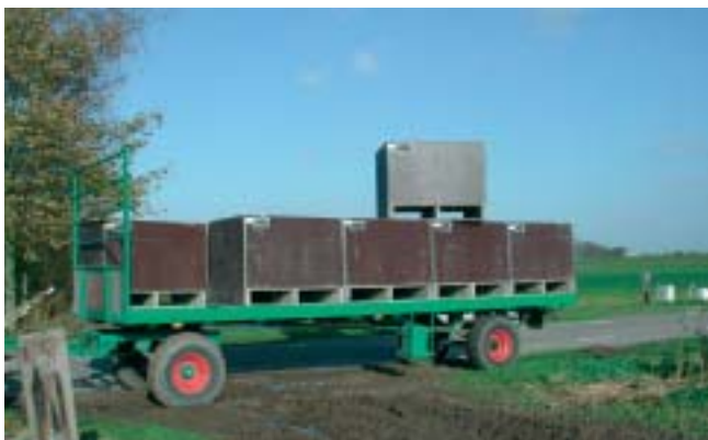
Een vloeistofdichte vloer op de aanhangwagen met rondom een opvanggoot gekoppeld aan een opvangbak
