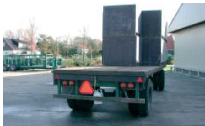
Een lichthellende vloer met in het midden van de aanhangwagen een goot met opvangbak
