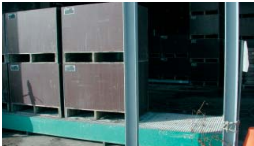
Via een lekbak onder de kuubkisten kan het overtollige vocht uit de ontsmette bollen goed opgevangen worden. De opgevangen vloeistof kan weer terug in het bad worden gebracht.
