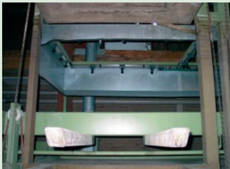
Een sproeier om fust na dompelen aan de buitenkant te reinigen
