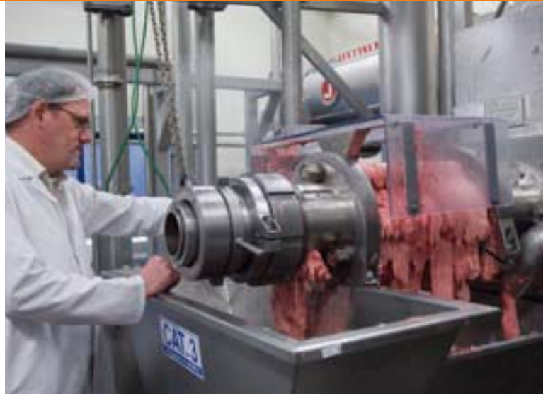
Het vlees wordt, met een schroefpers, door een zeef gedrukt.
