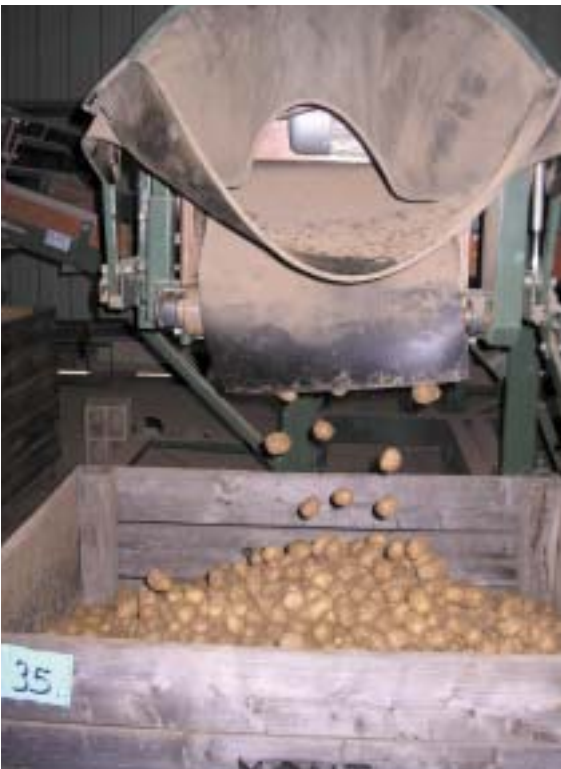
EARL Raymondin heeft in de Charante 90 ha pootaardappelen. Jaarlijks goet voor een oogst van ca. 2.200 ton. De sorteermachine – afkomstig uit Nederland – kan 15 ton per uur verwerken.
