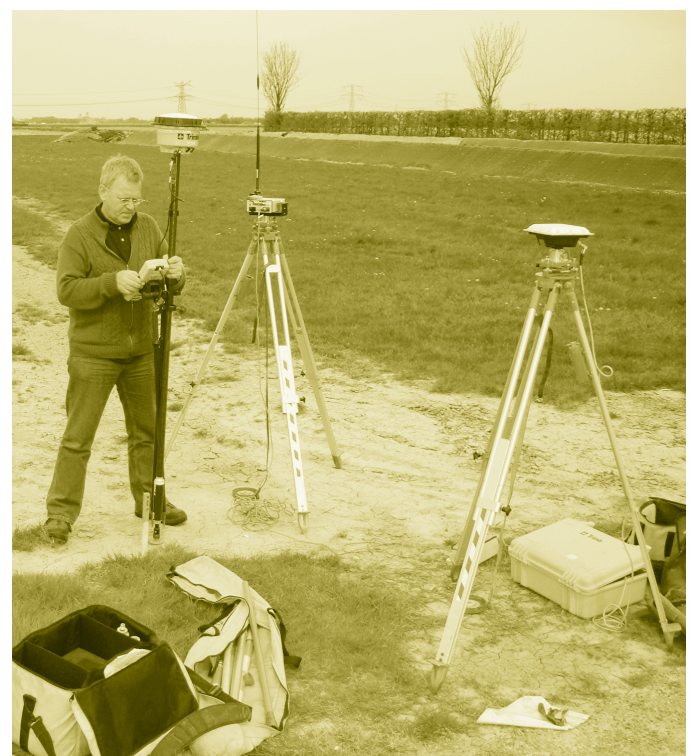
Figuur 3. RTK-GPS opstelling voor nauwkeurige positiebepaling.
