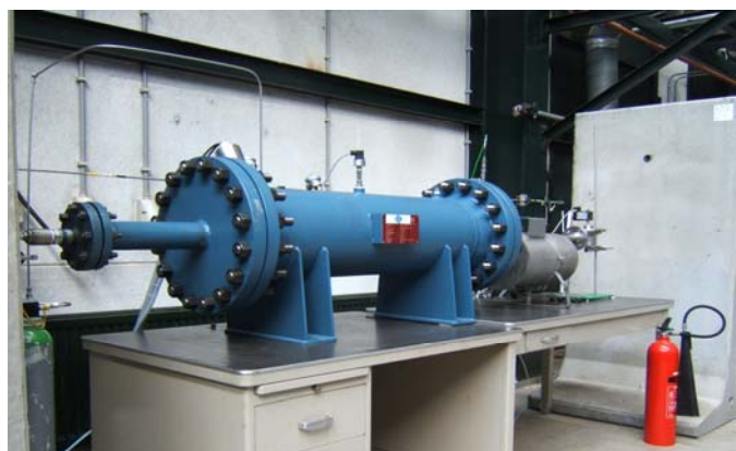
Figuur 15 HotCO 2 labopstelling: een holle buis met metaalkorrels
