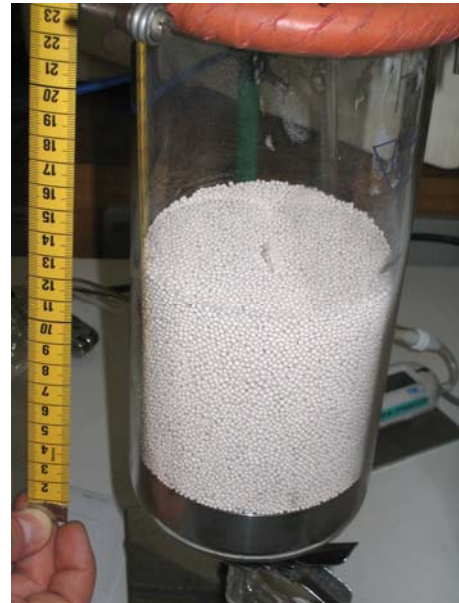
Figuur 14 Labopstelling met adsorberkorrels
