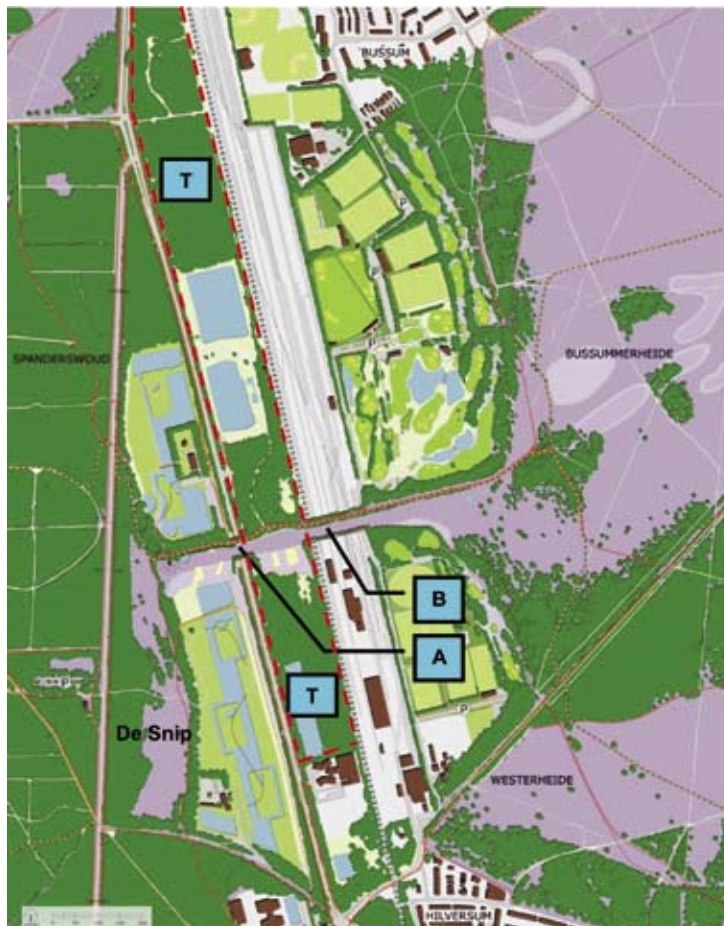
Figuur 2 Natuurbrug Zanderij Crailoo. A = Ecoduct over de Naarderweg; B = Ecoduct over het spoor en bedrijventerrein; T = Tussengebied.
