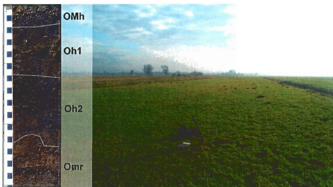
Figuur 6 Humusprofiel van boring 9048. De Omr-horizont bestaat uit deels veraard rietzeggeveen.
