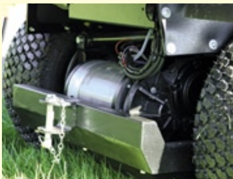
De elektromotor zit samen met de transmissie tussen de achteras.
