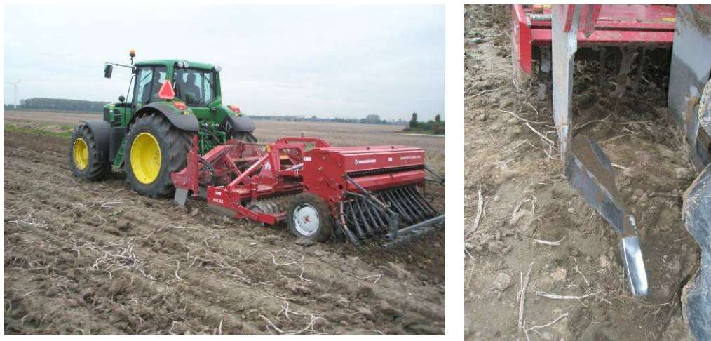
Figuur 6.3. Bodembewerking met de paragrubber-woeler van Kongskilde (links), close up van één van de woelpoten (rechts), oktober 2008.
