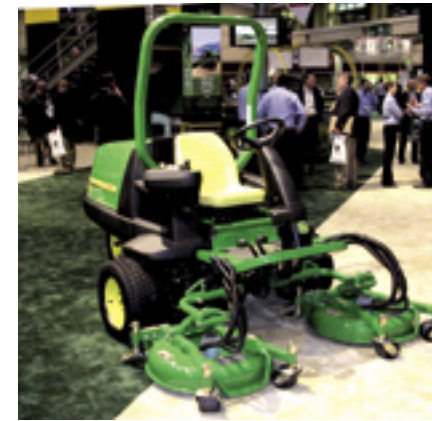
De dekken van de John Deere Terrain Cut 7400 driedelige cirkelmaaier kunnen individueel naar buiten schuiven.
