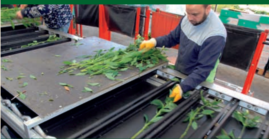
De sorteerder legt de takken op dezelfde manier één voor één en 'op de kop' in de sorteerder. Op deze manier ontstaat aan de bovenkant een 'gladde' bos.
