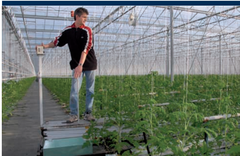
Bij het bedrijfsbezoek stelt de Stigas-adviseur vast dat het hekje rond het platform niet meer voldoet aan de normen. Het moet volledig zijn afgeschermd met aan de achterzijde een draaibaar hekje.
