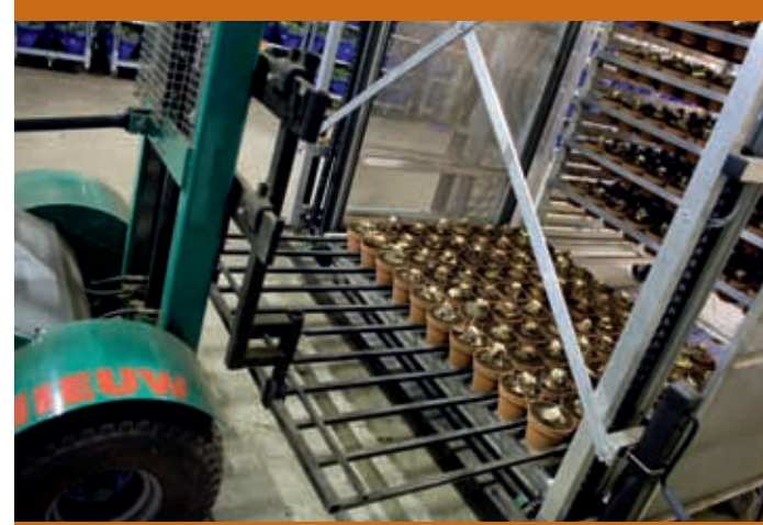
Scheffers werkt met verstelbare aluminium rekken. De potten hangen in deze rekken waardoor ze niet kunnen schuiven en er geen beschadigen tijdens het transport optreden.
