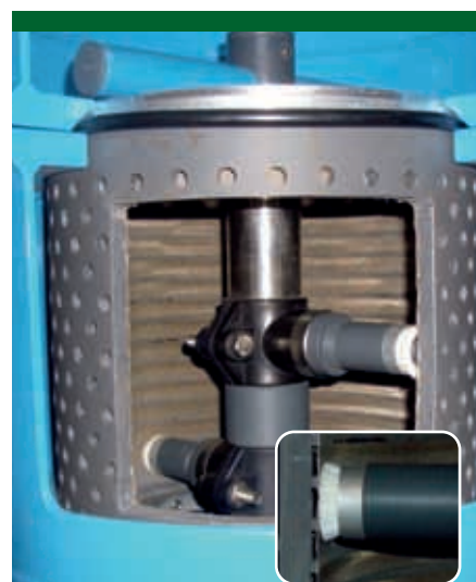
Dwarsdoorsnede van het zelfreinigend automatisch schermfilter van Meteor Systems. Bij een bepaald drukverschil komt het borstelsysteem in actie.
