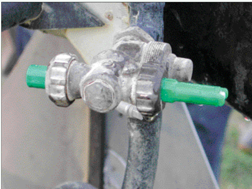
In de praktijkproeven werden verschillende venturidoppen gebruikt. Per bedrijf werd steeds met één type venturidop en met de standaard neveldop gespoten. Foto's: PPO-fruit
