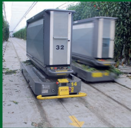
Automatisch transport over een inductiekabel.
