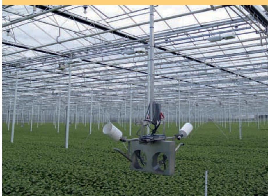
Het verdeelapparaat is verrassend eenvoudig en compact. Twee ventilatoren blazen de biologische bestrijders over het gewas, zodat een mooie verdeling ontstaat.
