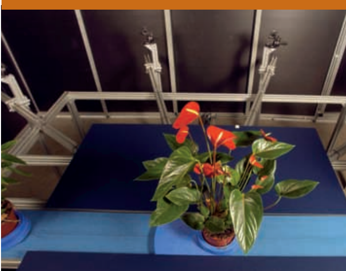
Door een plant met meerdere camera's te bekijken en daaruit de beste opname te filteren, is de foutkans sterk teruggedrongen.
