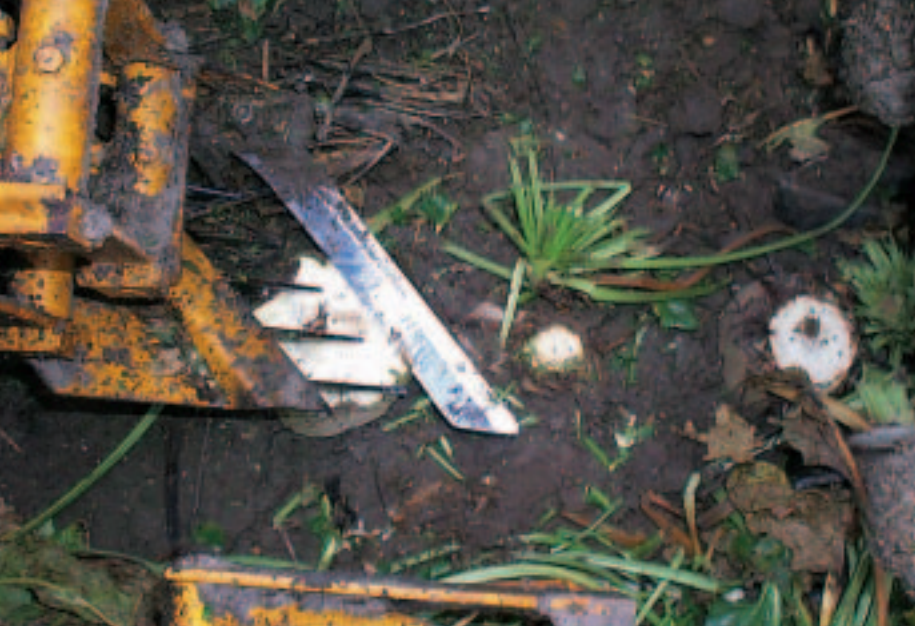
Figuur 3. De kopdikteregeling voorkomt extra koppen van de hoogste biet, die al is gekopt door de ontbladeraar.
