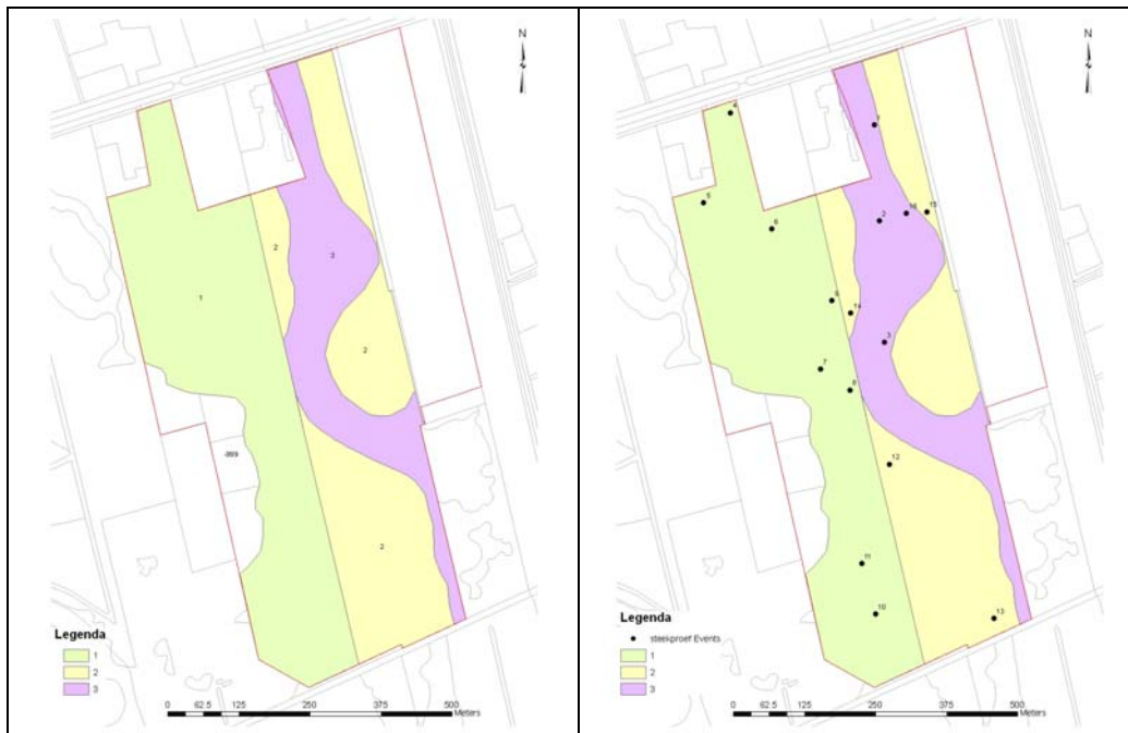
Figuur 3.2 verdeling van het gebied in strata (links) en ligging van de steekproefpunten (rechts). Het witte gedeelte met code -999 wordt volgens het inrichtingsplan opgehoogd en is buiten de stratificatie gelaten.
