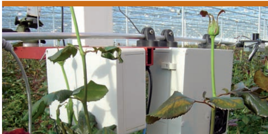
Growlab-apparatuur zendt elke vijf minuten de data draadloos naar Letsgrow.com.
