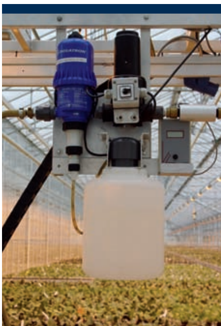
De spuitvloeistof moet voortduren bewegen om bezinken van de aaltjes te voorkomen.
