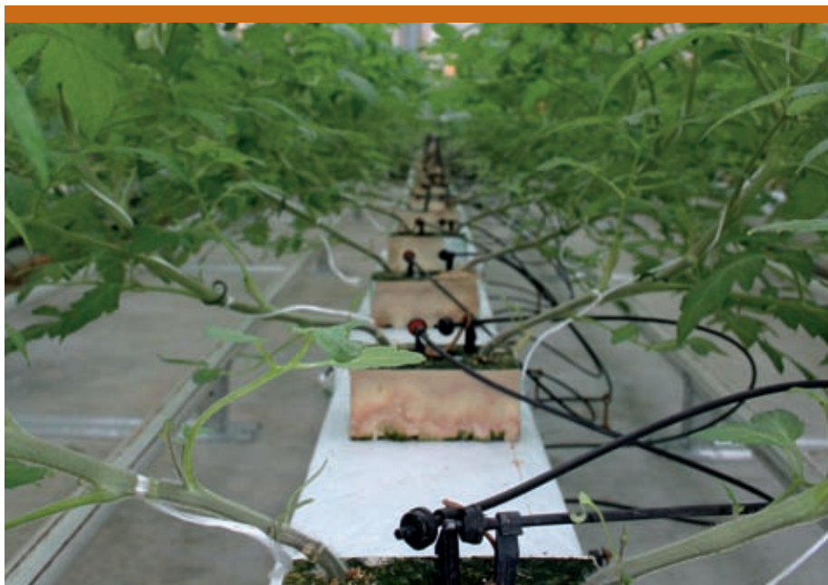
Er komen vaak grote verschillen voor in de afgifte van de druppelaars. Vrijwel alle problemen zijn te herleiden tot vervuild gietwater en schommelingen in de EC en de (pH).
