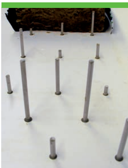
Een proefopzet van TNO's multi-zuurstofsensoren. Pinnen van uiteenlopende lengtes meten op verschillende diepten het zuurstofniveau.
