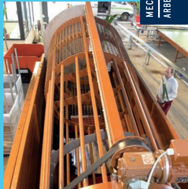
De afvalscheider 'sorteert' de potten, potgrond en noten. Dat beperkt de hoeveelheid afval tot een kwart.
