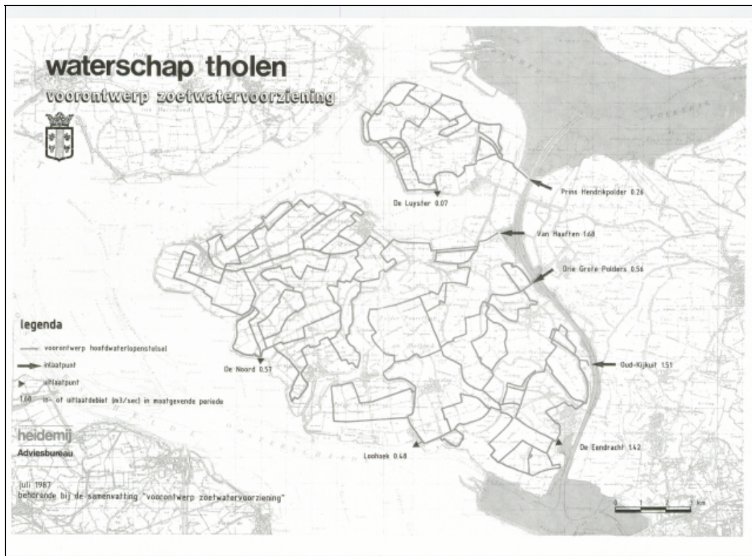
Figuur 6.4. Voorontwerp van een wateraanvoersysteem voor Tholen en St Philipsland (Dekker, 1995).
